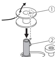
4. Inserire il capo del filo all'interno del foro laterale della spolina come mostrato in figura a fianco. Inserire la spolina vuota all'interno del perno avvolgi spolina facendo in modo che il suo foro sia allineato alla molla del perno stesso.
