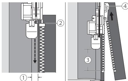
Fissare il piedino al perno di destra per cucire il lato sinistro della cerniera lampo. Cucire la cerniera lampo lungo il bordo di 3mm appena ripiegato.
