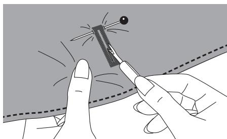
Inserire l'apri asola al centro delle due travette facendo attenzione a non tagliare i fili circostanti. Utilizzare uno spillino da inserire orizzontalmente alla travetta finale come dispositivo di arresto.
