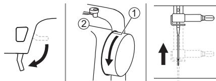
10. Abbassare la leva alza piedino. Portare l'ago in alto ruotando il volantino verso sè; la freccia disegnata sul volantino deve combaciare con la linea posta sulla scocca laterale.
