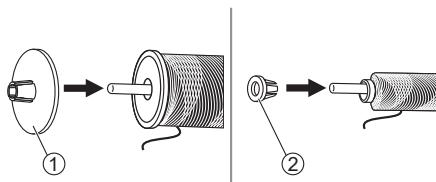
1. Posizionare il roccetto di filo ed il fermo spola all'interno del porta spola orizzontale. Scegliere il fermo spola (grande o piccolo) in base al diametro del roccetto di filo spingendolo contro il roccetto fino a farlo aderire ad esso.
