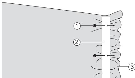
Mettere alcuni spilli sul rovescio del tessuto per fermare in posizione il nastro elastico, avendo cura che venga distribuito uniformemente.
