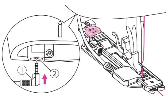
Installare il piedino asola elettronica introducendo il cavo del connettore nel relativo innesto posto sopra la barra ago.
