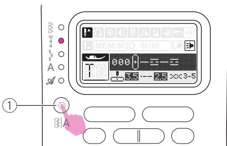
Quando si accende la macchina la luce LED illumina il primo gruppo nel riquadro del quale fanno parte i punti a selezione diretta. Premendo ancora la sequenza scorre ai gruppi successivi.
