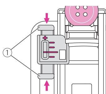
Considerando che ogni bottone ha diametro e spessore unici attraverso la leva bilanciamento asola è possibile regolare la chiusura dell'asola in caso di chiusura anticipata o posticipata di una delle due travette su tessuti particolari. Il tasto regolazione asola invece permette di stabilire lo spessore di ciascuna travetta mantenendo invariata la distanza fra loro; di conseguenza lo spazio all'interno dell'asola aumenta oppure diminuisce.
