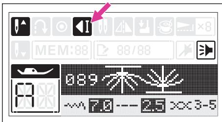
Quando la macchina sta cucendo: impostando i punti a selezione diretta da 6 a 9 o punti standard da 001 a 008 e da 026 a 099 oppure ancora punti Quilting da 000 a 046 e da 048 a 049 premendo il tasto nodo automatico, la macchina completa la sequenza disegno in corso, esegue 3 punti sulla stessa battuta d'ago per poi fermarsi automaticamente. Se si preme nuovamente il tasto mentre la macchina è in corsa, la funzione viene annullata.
