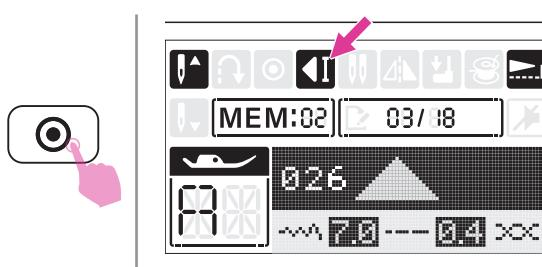
Quando la macchina sta per terminare la cucitura esegue 3 punti sulla stessa battuta d'ago alla fine della combinazione dell'ultima unità in sequenza; il display LCD mostra l'icona autostop. Premendo il tasto start/stop ricomincia la cucitura della sequenza.
