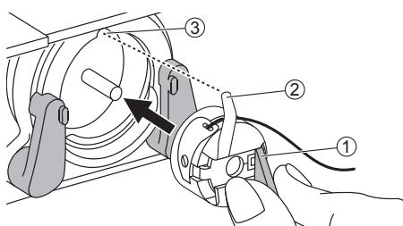
Inserire la capsula nel vano crochet afferrando la linguetta e in modo che il perno verticale si incasti con un click al relativo incavo del vano crochet. Chiudere lo sportello porta spolina.
