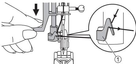
Abbassare lentamente la leva infila ago e contemporaneamente appoggiare il filo sotto il suo guidafilo facendolo passare da destra verso sinistra.
