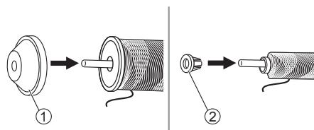
1. Posizionare il rocchetto di filo ed il ferma spola all'interno del porta spola orizzontale. Scegliere il ferma spola (grande o piccolo) in base al diametro del rocchetto di filo spingendolo contro il rocchetto fino a farlo aderire ad esso.
