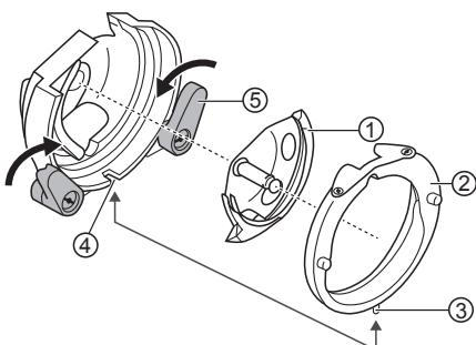
Rimontare i componenti posizionandoli come mostra la figura a fianco: per primo il crochet quindi il ferma crochet (lo sperone inferiore deve incassarsi al relativo incavo posto sul bordo del vano crochet). Richiudere i due ganci blocca crochet.
