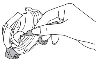
Lubrificare l'area interna del vano crochet con alcune gocce di olio specifico per macchine per cucire; ruotare il volantino verso sè di un giro completo per distribuire l'olio in tutta l'area.
