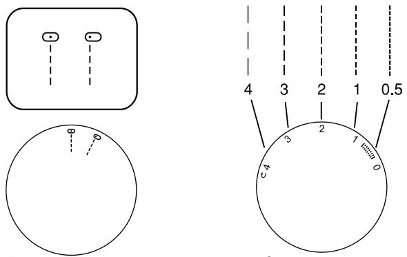
Per la selezione del punto zigzag, ruotare l'apposito selettore in corrispondenza di "~~~" (figura 3).
