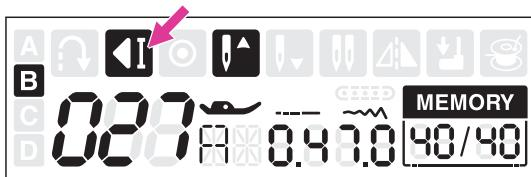
Premendo nuovamente il tasto marcia indietro la funzione viene disattivata: la macchina esegue 3 punti sulla stessa battuta d'ago alla fine della combinazione. Il display LCD mostra l'icona auto-stop durante la cucitura dell'ultimo punto in sequenza.
