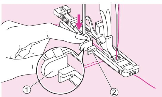
Abbassare la leva asola automatica fino al suo punto più basso e spingerla dietro l'apposito supporto di blocco.
